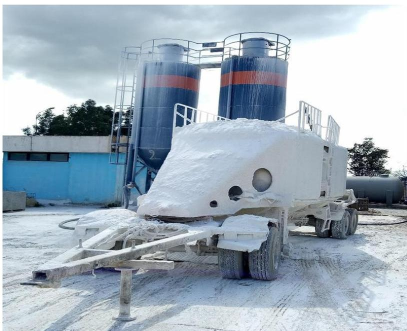
Figure II.7 : Machine pour produire le lait de chaux.
