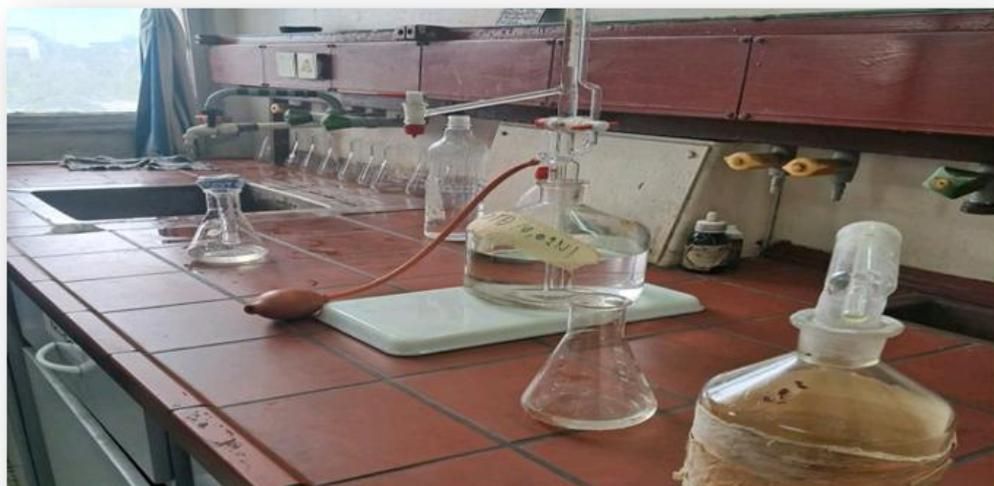
Figure II.22 : Dosage volumétrique du TA et TAC.
