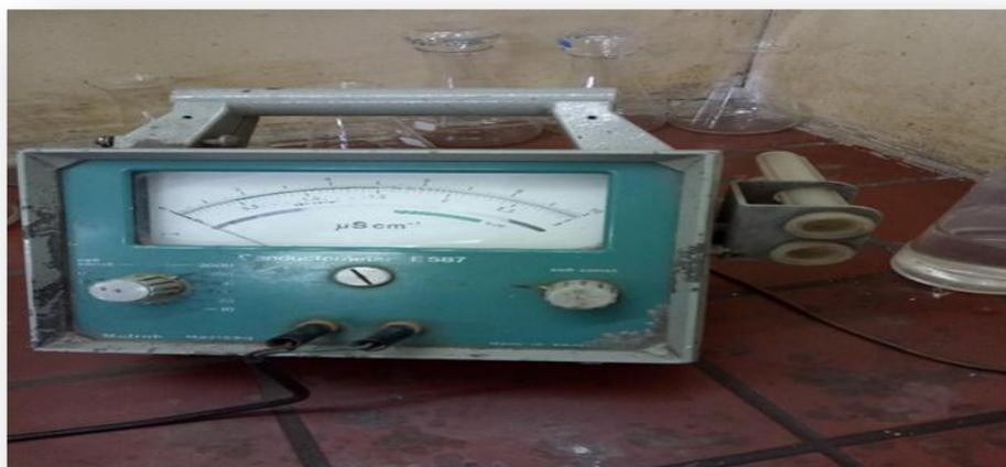
Figure II.41 : Conductimètre « E 587 ».
