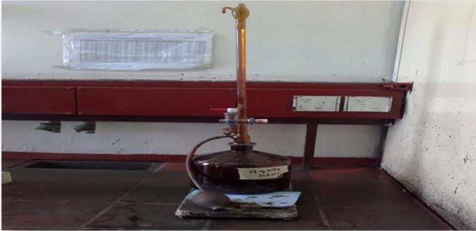
**Figure II.35 :** Dosage volumétrique du  $\text{Cl}^-$ .
