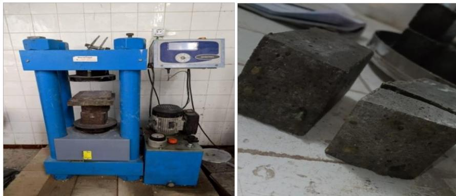
**Figure II.20** : Machine d'essai de compression
