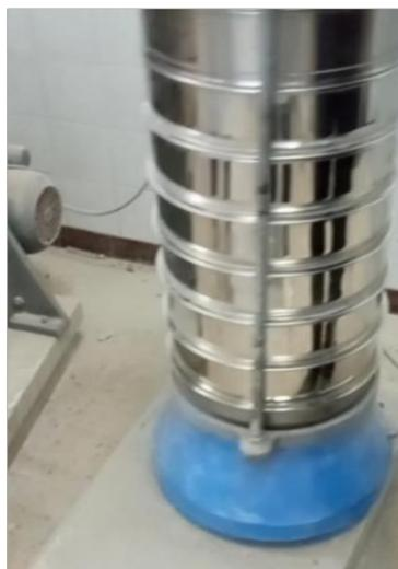
**Figure II-8** Série de tamis utilisés pour l'analyse granulométrique
