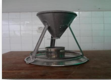
**Figure II. 5:** La masse volumique apparente
