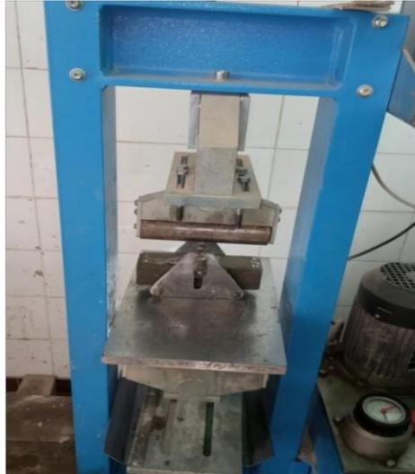
**Figure II.16 :** Conduite de l'essai de traction par flexion
