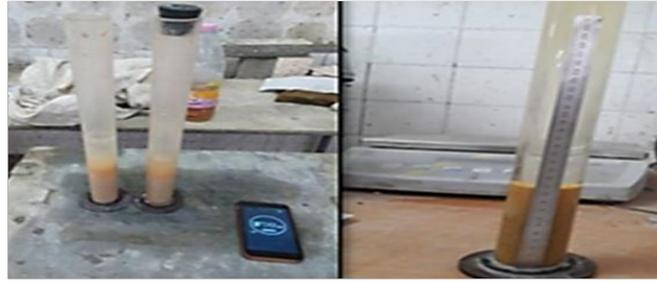
**Figure II-6** : Essai de l'équivalent de sable
