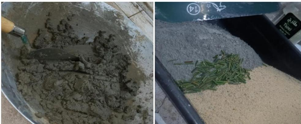
**Figure II.9 :** mélange manuellement d'un mortier    **Figure II.10 :** mélange d'un mortier fibré
