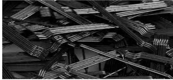
**Figure I.9.** Fibres d'acier
