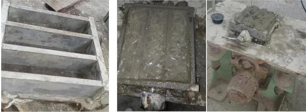
Figure II.11: Fabrication et moulage des éprouvettes.
