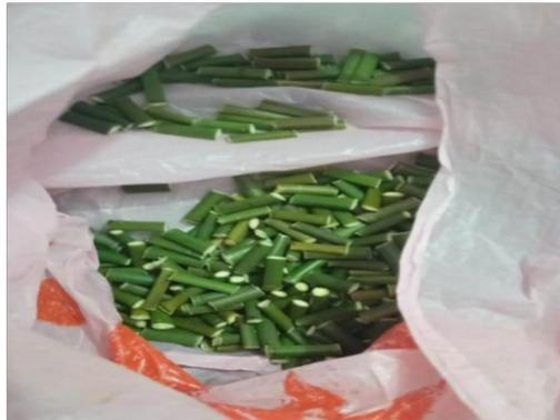
**Figure II.3** : fibres de jonc découpées et utilisées
