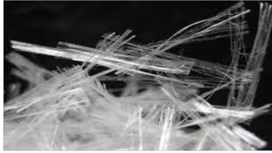
**Figure I.11.** Les fibres de polypropylène
