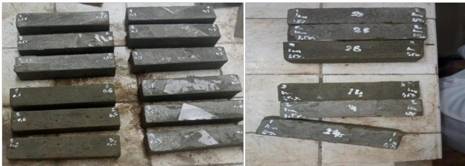
Figure II.15 : Eprouvettes à l'état durci
