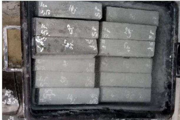
Figure II.13 : Conservation des éprouvettes dans l'eau
