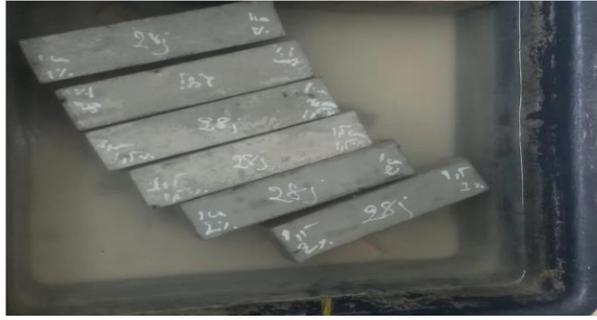
**Figure II.22** : dispositif de mesure d'absorption d'eau par immersion totale
