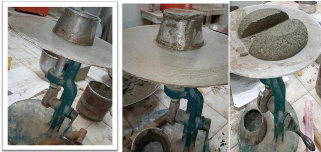
**Figure II.14** : Essai d'étalement à la table à secousses
