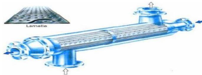
**Figure 2.12** Echangeur lamellaire
