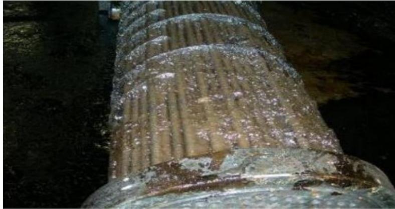
**Figure 2.16** Exemple d'un faisceau de tubes d'un échangeur encrassé
