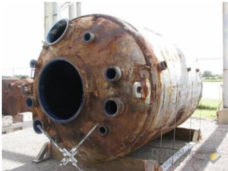
**Fig.IV.1** : L'influence corrosive sur un réacteur
