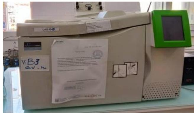
**Fig.IV.3.** Chromatographe en phase gazeuse GC-065
