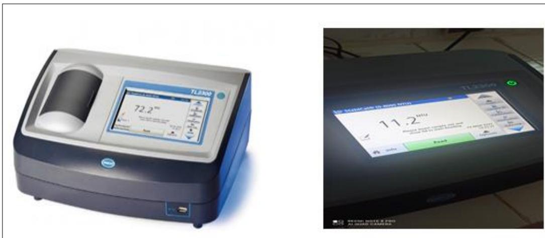
**Figure 16** : Turbidimètre (TL2300) (HACH)
