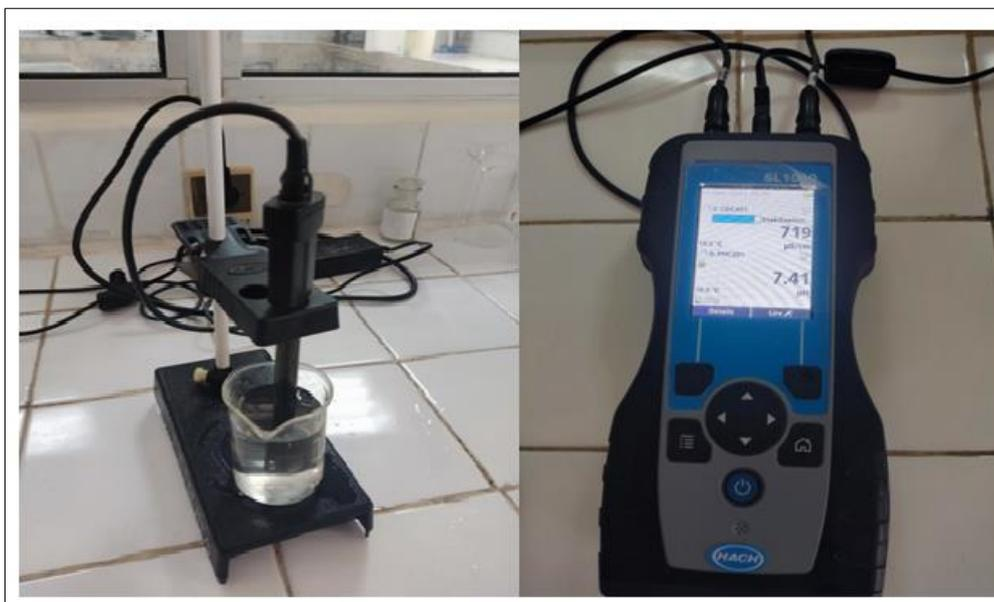
Figure 19 : méthode de la mesure de pH
