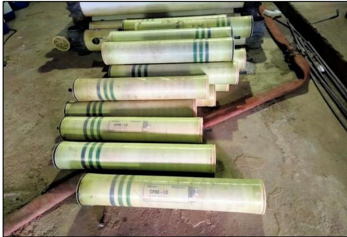
*Figure II.9 : membranes colmatées dans la zone EST.*
