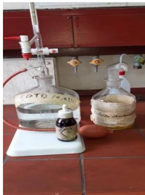
Figure III.7: Montage de dosage volumétrique du TH.
