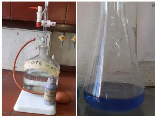
Figure III.8: Montage de dosage volumétrique du  $T_{Ca^{2+}}$
