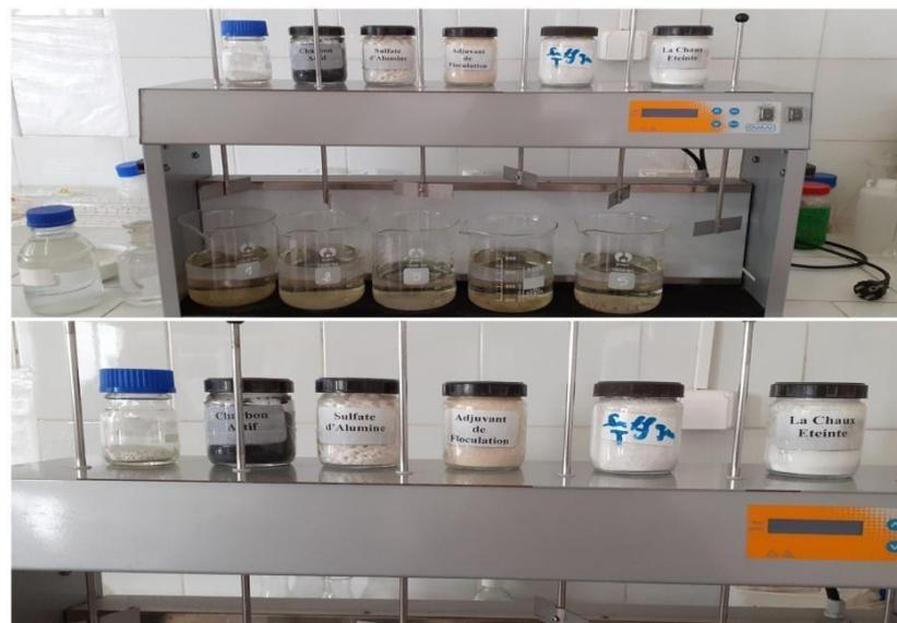
**Figure. II.8 :** Essai du Jar-test par les produits
