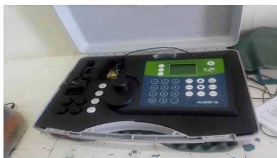
**Figure III.12:** Turbidimètre
