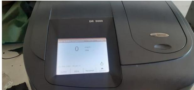
**Figure III.12:** Spectrophotomètre « Dr 5000 »
