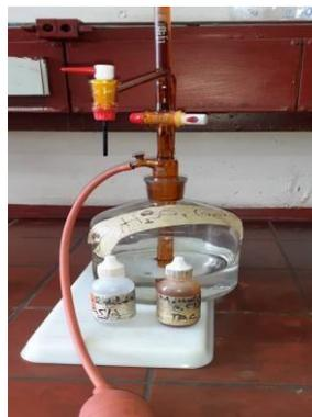
**Figure III.4:** Montage de dosage volumétrique du TA et TAC.
