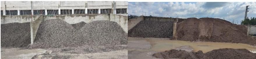
**Figure I.16:** Pré-stockage des granulats dans des box
