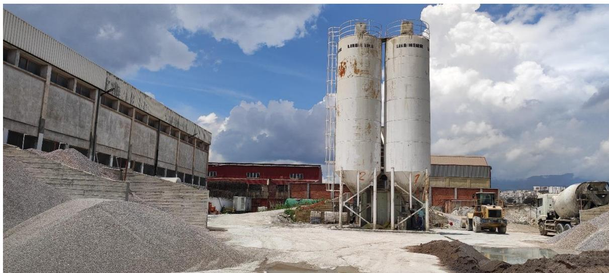
**Figure II.1 : Centrale à béton**
