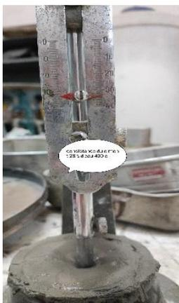
**Figure II.3** : Essai de consistance
