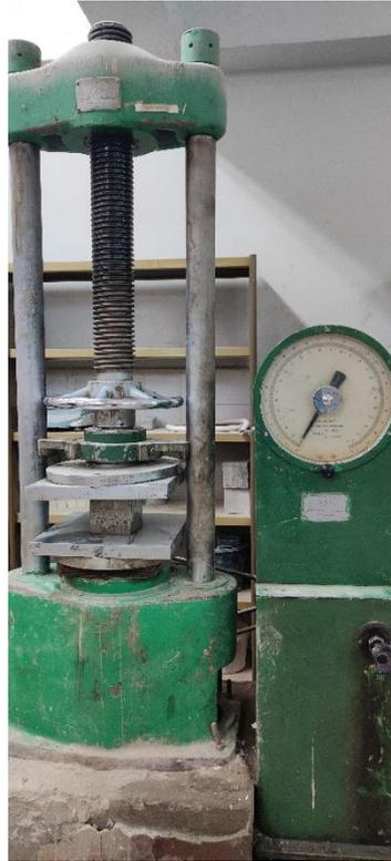
**Figure II.11.** presse de compression du béton
