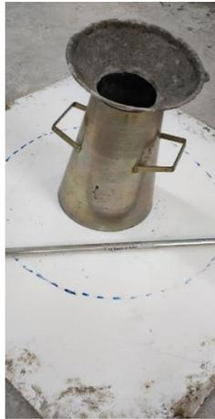
**Figure II.10.** Cône d'Abrams
