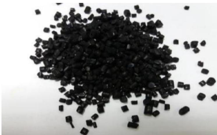
**Figure IV-3:**Photo représentatif du mélange PEHD-NC granulés.
