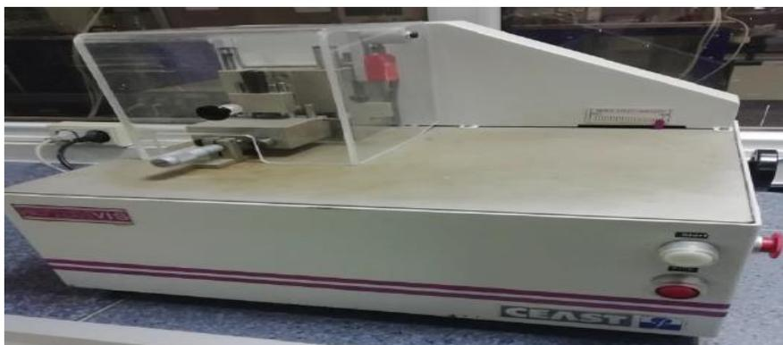
**Figure IV-10:**Entailleuse (Notch Vis) (labo CP2K)
