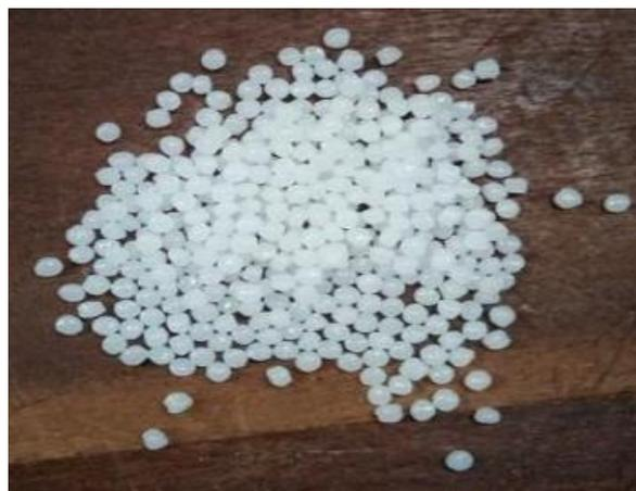
**Figure IV-1** :PEHD grade TR-402 sous forme de granules
