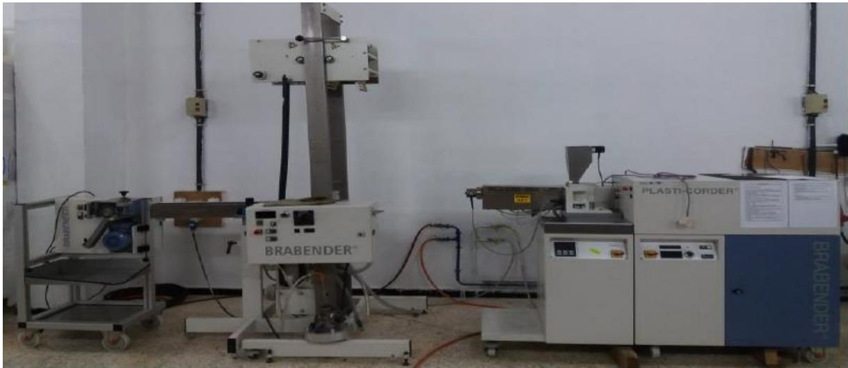
**Figure IV-5:** Extrudeuse mono-vis de laboratoire [1]
