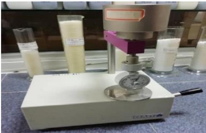
**Figure IV-22:** Photo représentative d'un Appareillage de mesure de la dureté SHOR D.
