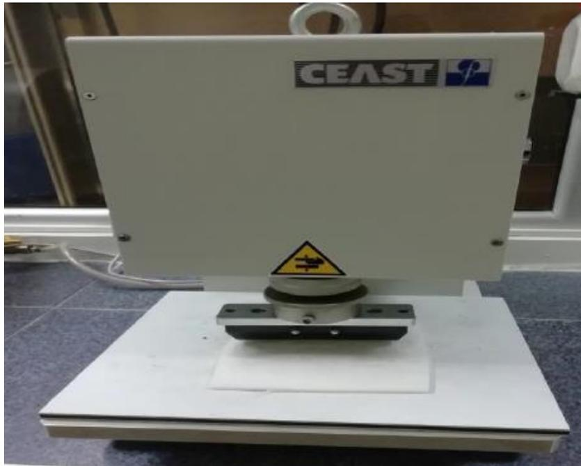
**Figure IV-8:** Appareillage d'une poinçonneuse « Presse pneumatique à découper » [1]
