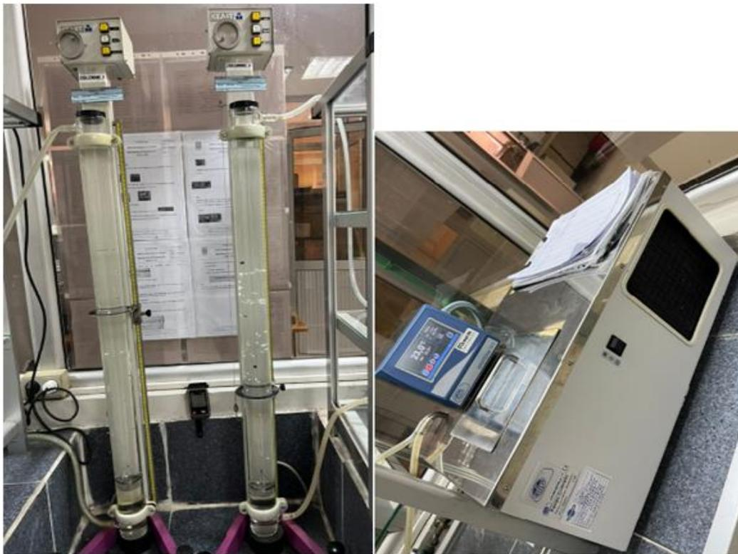
**Figure IV-12:** Appareil de mesure de la densité (labo CP2K)
