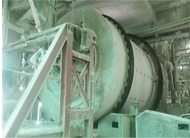
**Figure III.3 :** Granulateur
