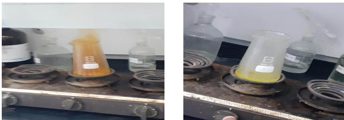
**Figure IV.4 :** Préparation du protocole opératoire pour la mesure du taux de P<sub>2</sub>O<sub>5</sub> total.
