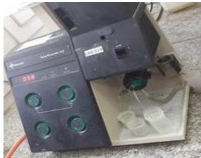
**Figure IV.9 :** Spectrophotomètre à flamme.
