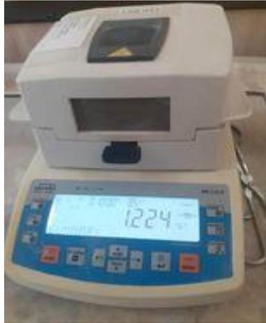
**Figure IV .2 :** L'appareil d'analyse pour calculer le taux d'humidité.
