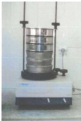
**Figure IV.8 :** Une rangé de tamis sur une machine à tamiser
