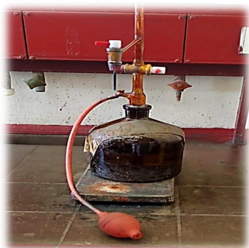
Fig.26- Dosage volumétrique du \text{Cl}^-
