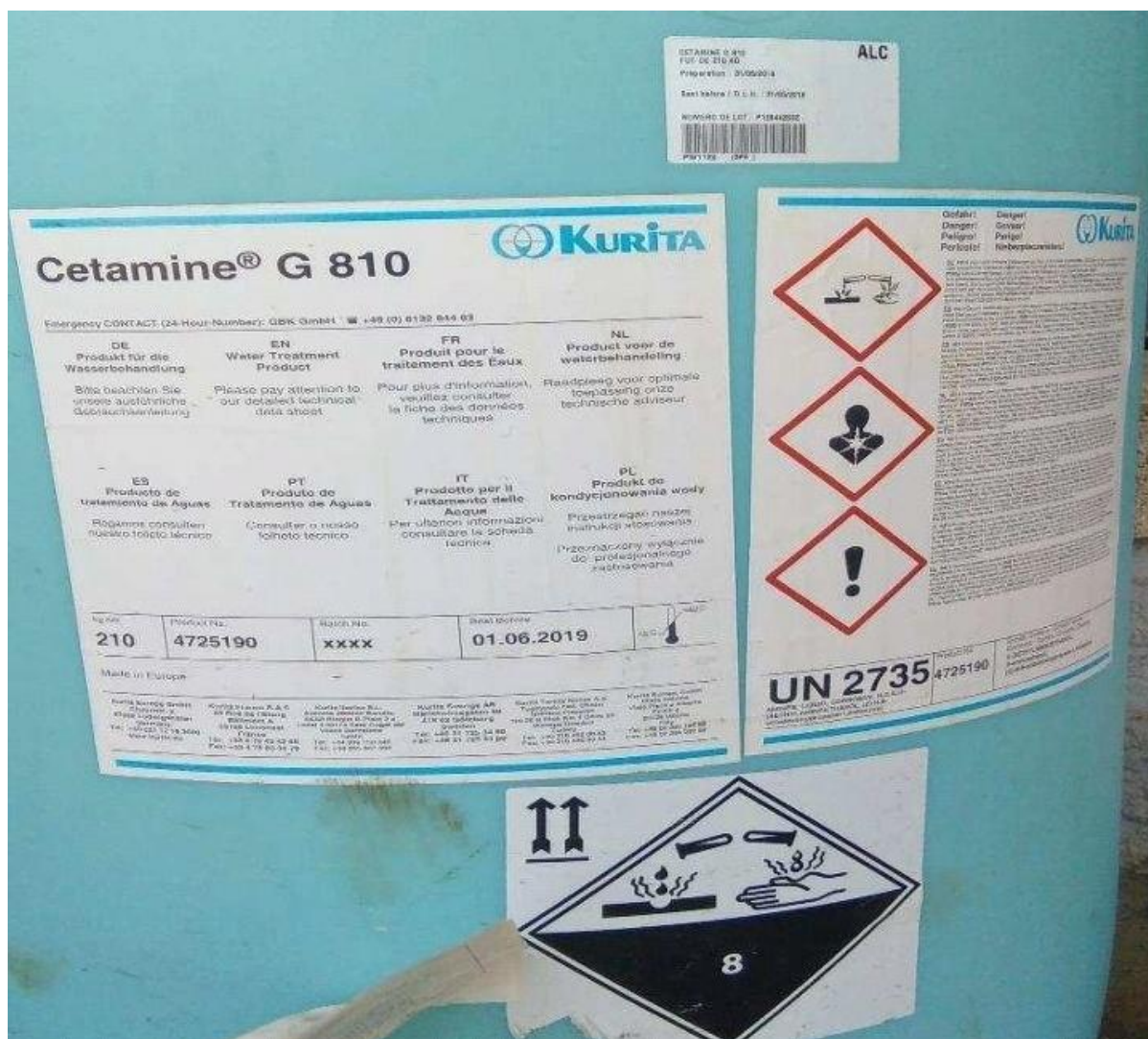
Fig.31- Inhibiteur (Cetamine G810) utilisé depuis 2019 dans la chaudière SITERM[11]
