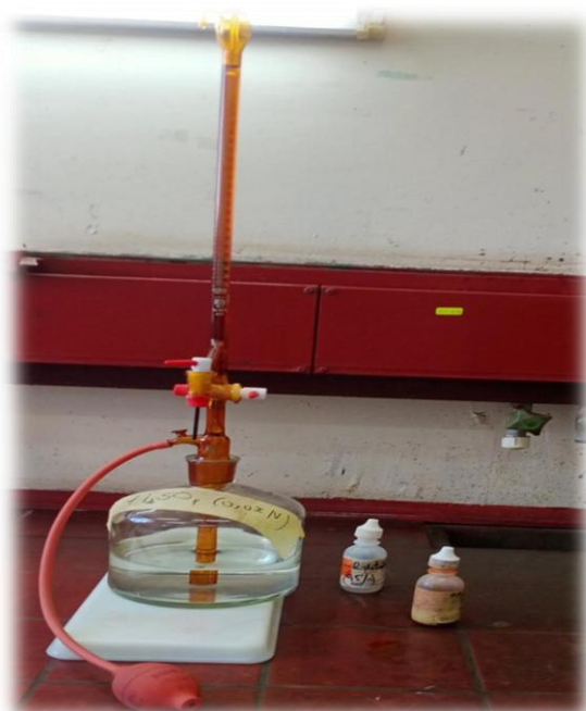
Fig.24- Dosage volumétrique du TA et TAC
