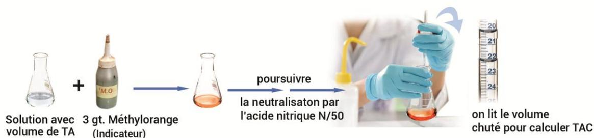
Figure (5) : Détermination du TAC (Titre Alcalimétrique complet)
