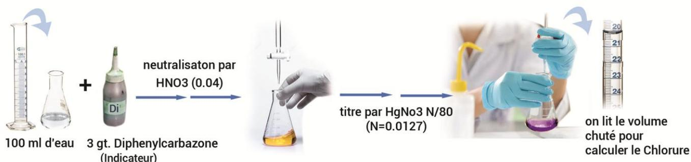
Figure (6) : Détermination du Chlorure dans l'eau
