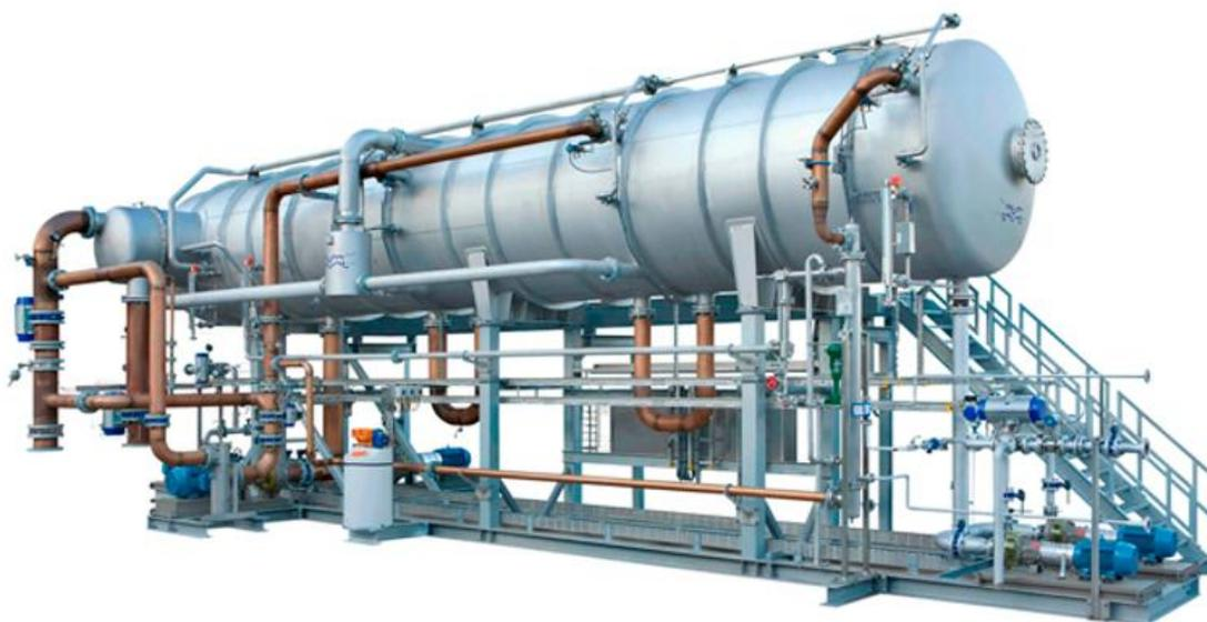
Figure (27) : Unité de Distillation Multi Effets (MED). [14]
