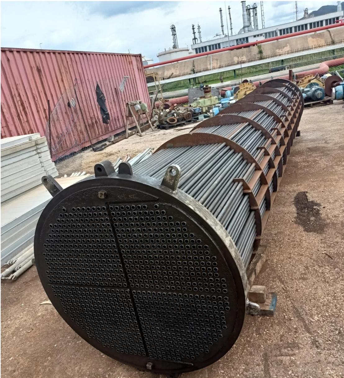
Figure 1.15 : faisceau tubulaire[18].
