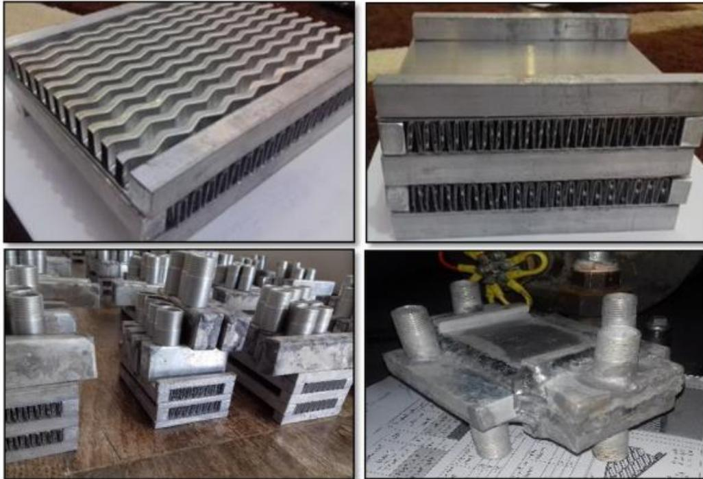
Figure 2.16 : La structure géométrique de l'échangeur de chaleur compact à plaques et ailettes multifluide[37].
