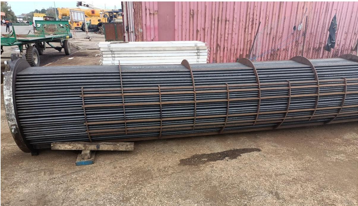
Figure 1.20: Faisceaux de l'échangeur de chaleur[18].
