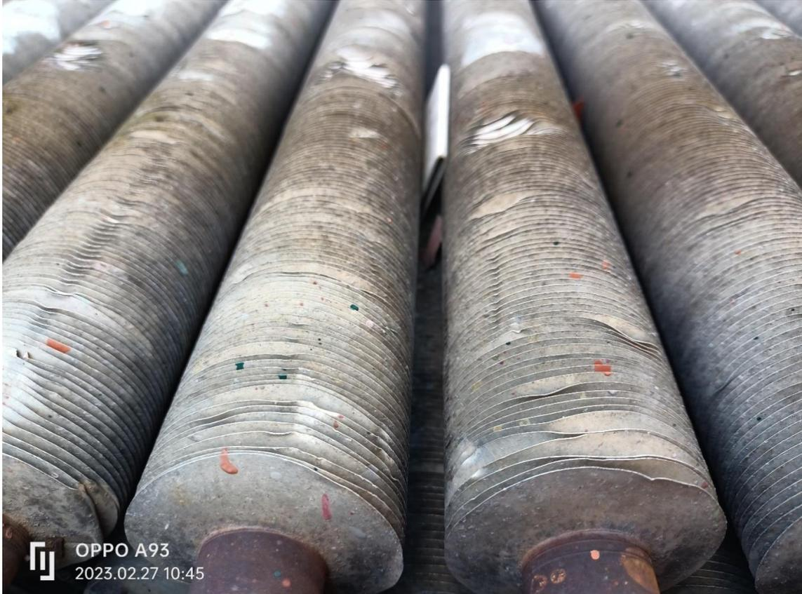
**Figure 1.14 :** échangeur à ailettes (photographié lors du stage effectué à Sonatrach-Skikda)[18].
