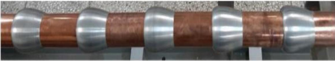
Figure 2.19 : Disposition des turbulateurs dans l'anneau [40].
