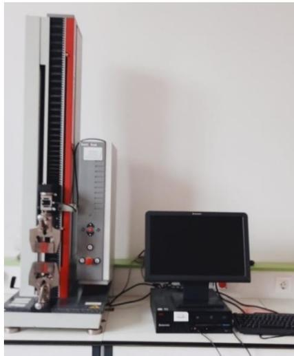
**Figure 2.10 :** Machine d'essais de traction pilotée par ordinateur.
