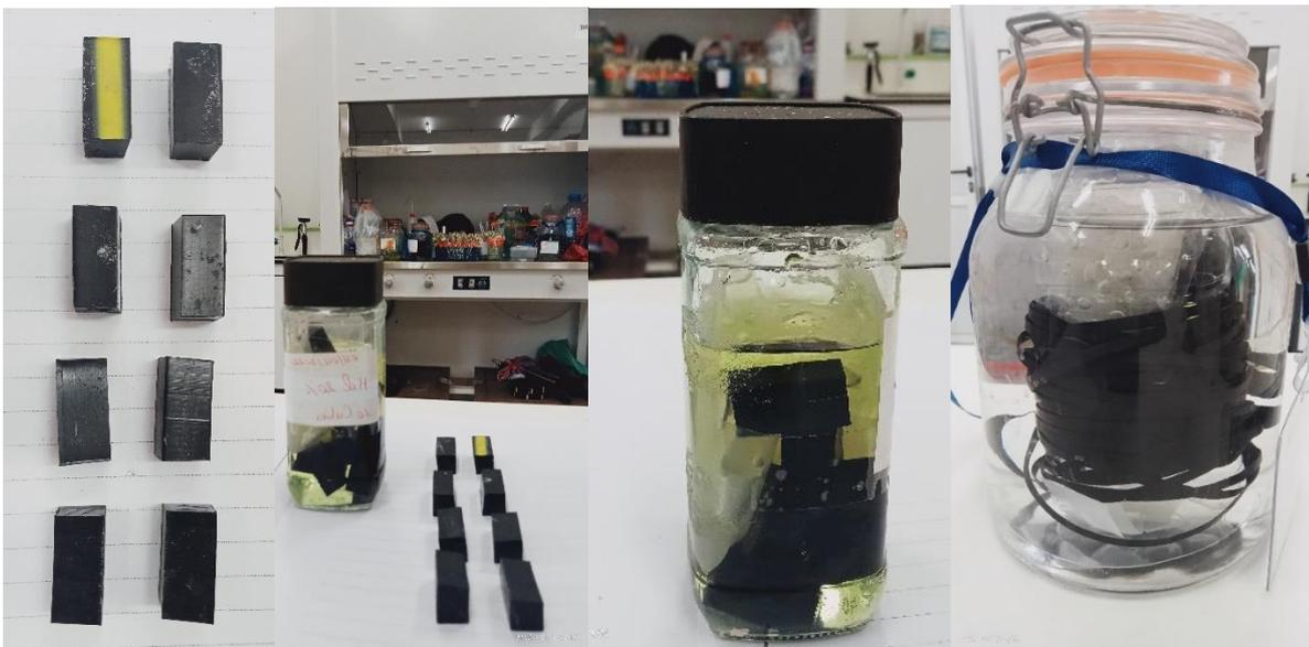
**Figure 3.2 :** Conditionnement des éprouvettes pour les tests de sorption.
