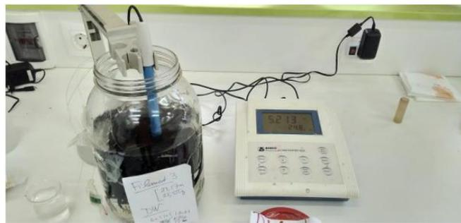
**Figure 2.7 :** Dispositif pour la mesure du pH de l'environnement considéré.
