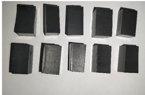
**Figure 2.9 :** Spécimens pour tests de sorption.
