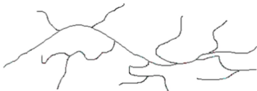
**Figure 1.1 :** Schéma d'une chaîne ramifiée de PEBD [11].
