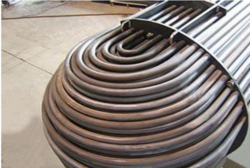
**Figure 6 :** Echangeur de chaleur tube en U
