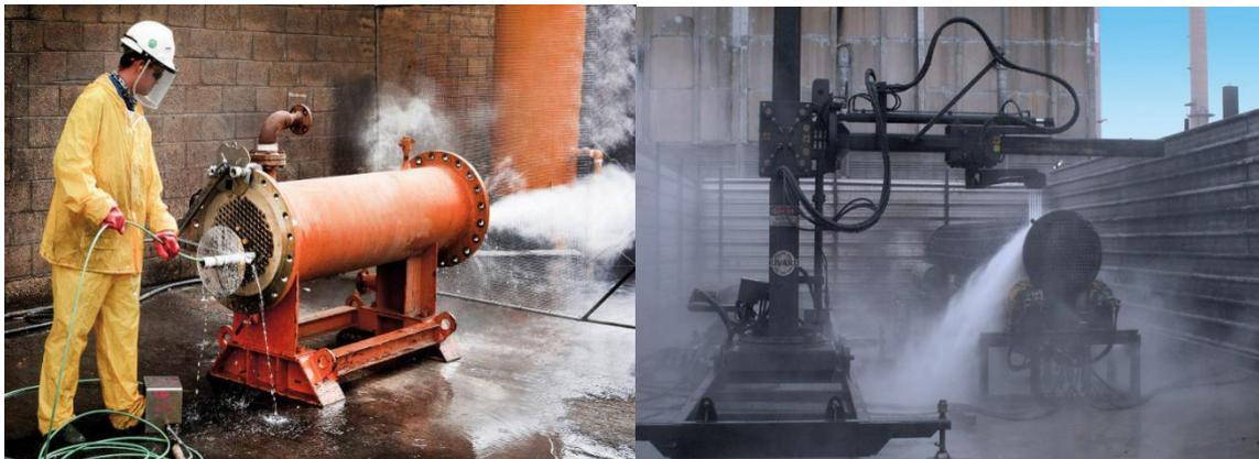
Figure 18 : Nettoyage des échangeurs
