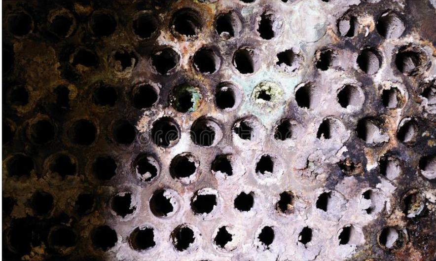
**Figure 16** : Encrassement des tubes dans un échangeur
