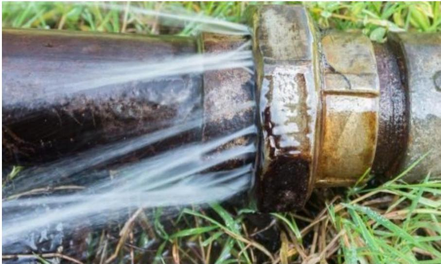
**FIGURE I-4** Effet d'un coup de bélier sur une conduite.
