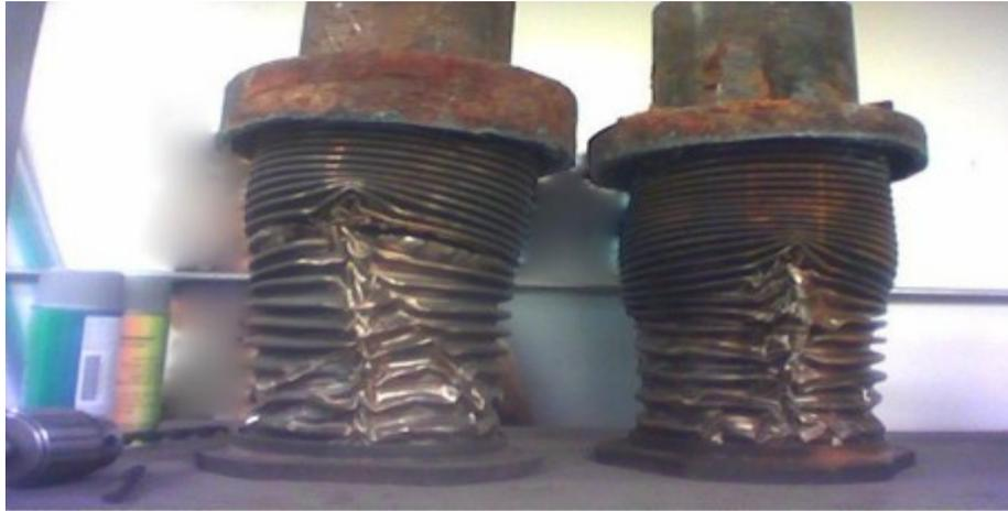
**FIGURE I-3** Joint de dilatation détruit par un coup de bélier
