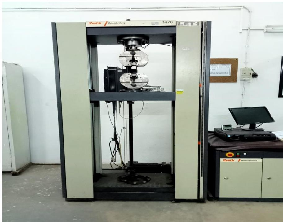
**Figure 24 : Machine d'essai de traction / Zwick 100KN**
