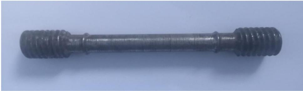
**Figure 23 : Photographie de l'éprouvette normalisée**
