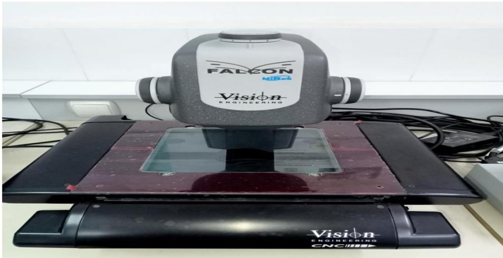
Figure 25 : Microscope optique Falcon Vision
