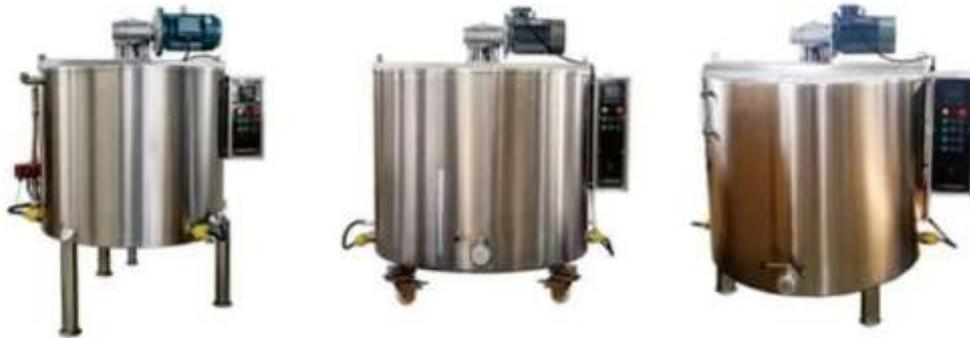
**Figure II.3** :Réservoir de maintien de la température
