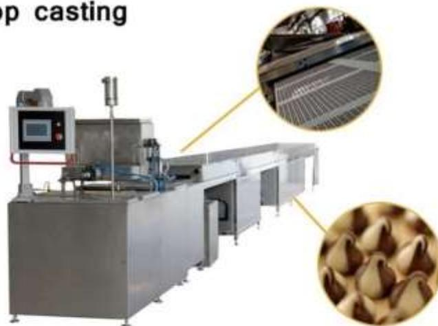
**Figure II .5 :** Machine de coulée de gouttes de chocolat
