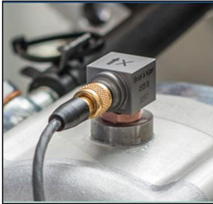
**Figure I.18.** Capteur de vibrations.
