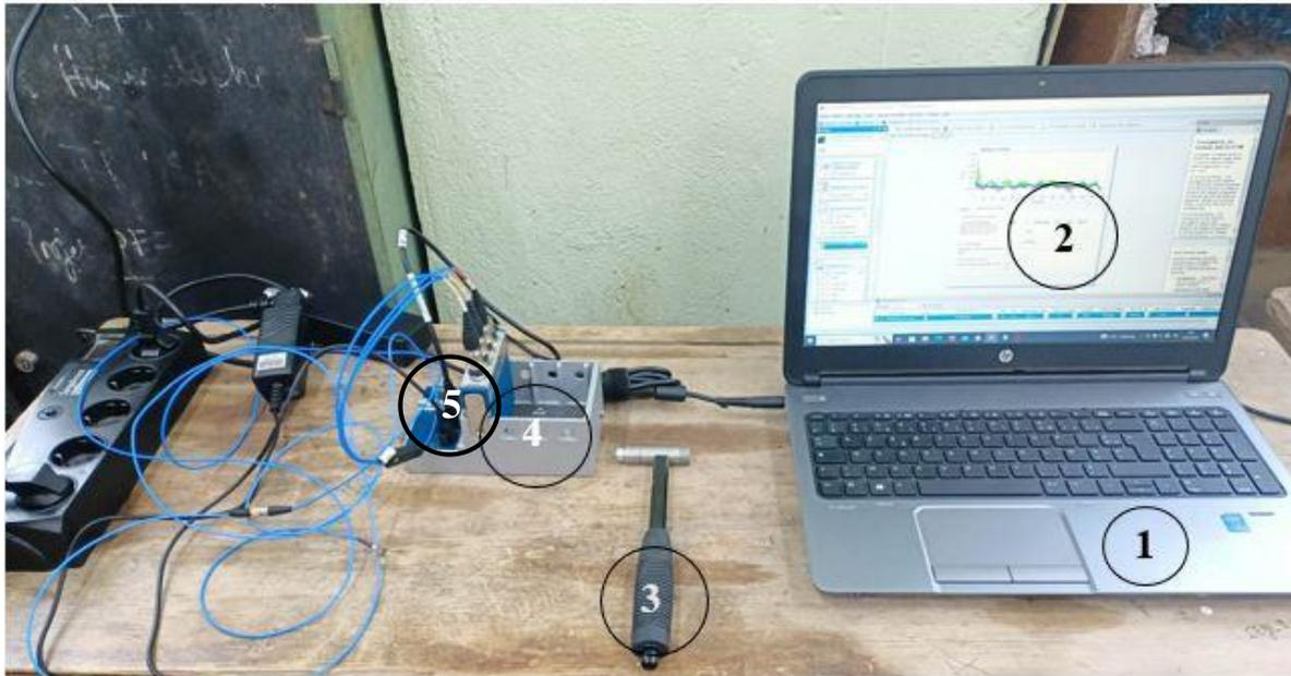
FigureII.10. Le matériel utilisé lors de l'analyse vibratoire.
