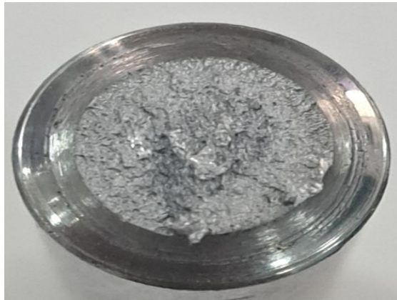
Fig. V.13. Facies de rupture par fatigue de l'acier 100C6 traité par brunissage
