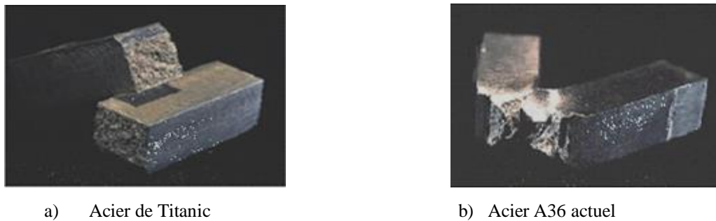
Fig. II.2 Rupture des matériaux : a) Rupture fragile de l'acier du Titanic, b) Rupture ductile d'un acier A36
