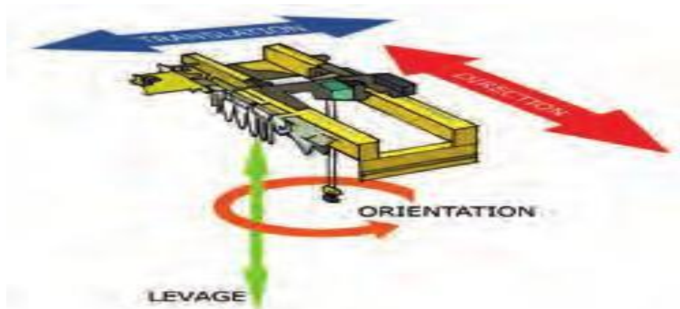
Figure II.1 Pont roulant : structure générale
