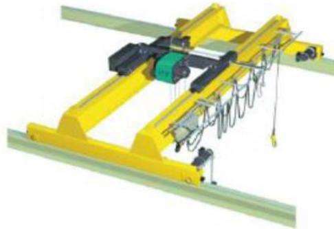
Figure 2: Exemple de pont roulant Bipoutre
