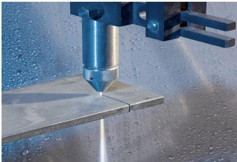
**Figure 16 : Découpage par jet d'eau**
