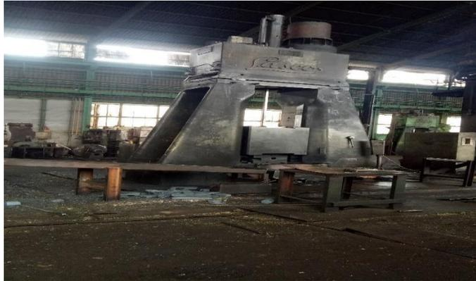
Figure 12 : marteau de KH 500 modèle LASCO
