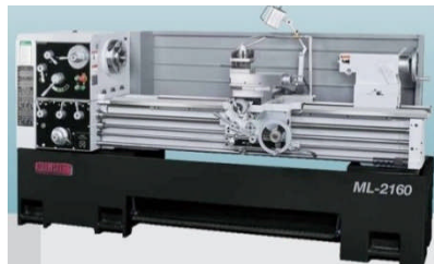
Fig 3: Tour parallèle à charioter, fileter série ML | Devis
