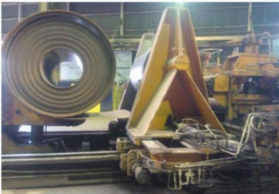
Figure 13 : Chaise support bobine et le dévidoir [3].
