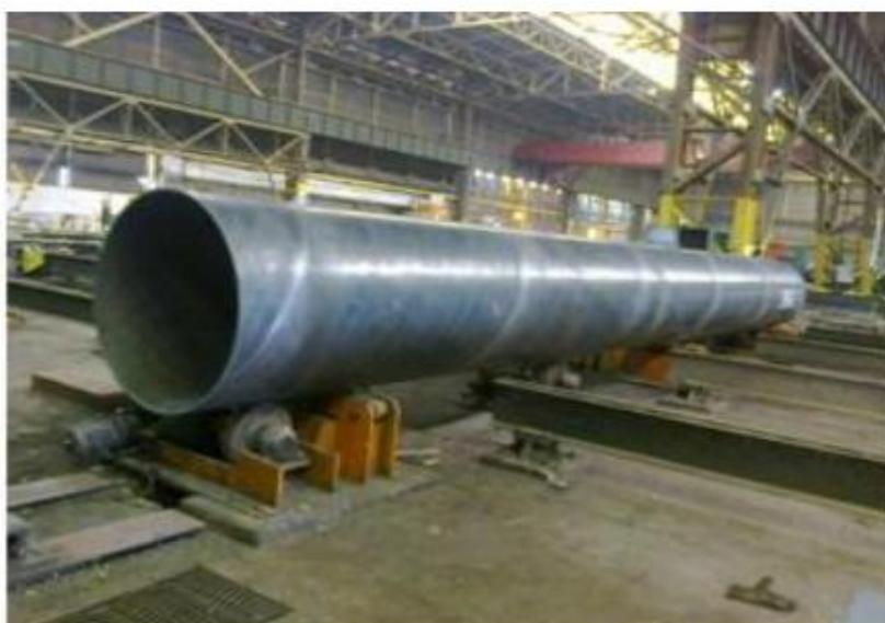
Figure 01 : Les tubes soudés sous la forme en spirale [1].
