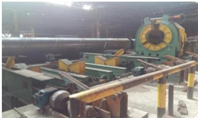
Figure 07 : Vue de la chanfreineuse de tubes.
