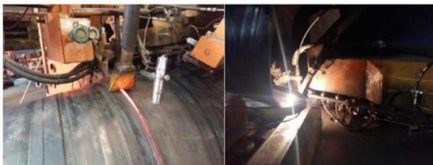
Figure 14 : Soudage SAWH à l'intérieur et à l'extérieur du tube [1].
