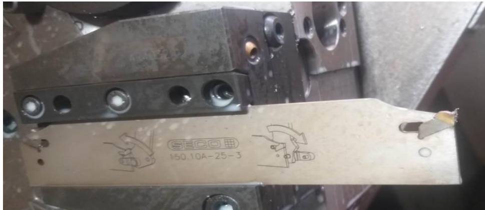
Figure III.11 : outil à gorger et à tronçonner
