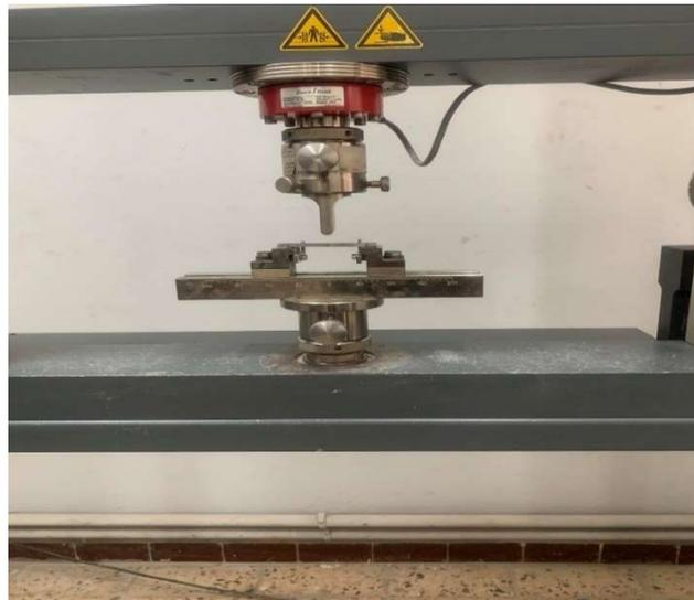
**Figure (III-4): La mise en place des éprouvettes**
