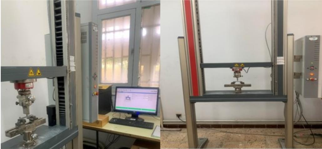
**Figure (III-2): Machine d'essais Zwick/Roell Z020 [20KN]**
