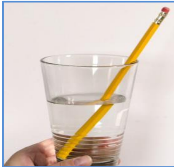
Figure (1.3) : Expérience du crayon plongé dans un verre d'eau illustrant le phénomène de réfraction.
