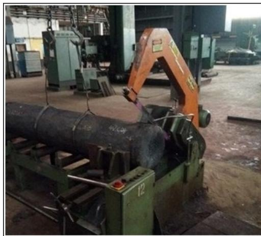
*Figure III. 12 Scie mécanique (EBS3604)*
