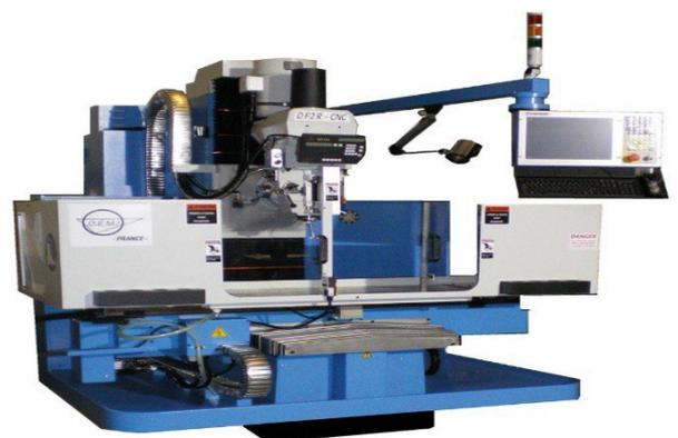
Figure I. 2 : fraiseuse à C.N [4]
