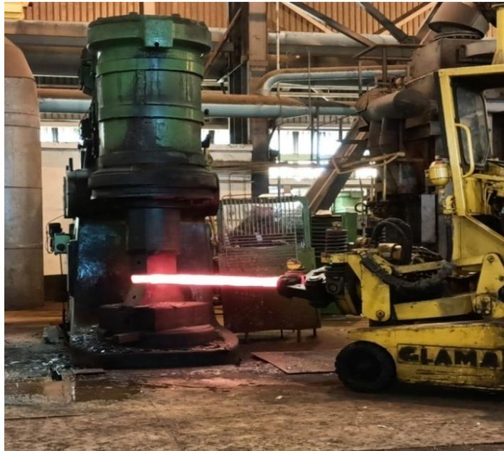
*Figure III. 11 : Illustration des opérations de forgeage sur Marteau pilon*
