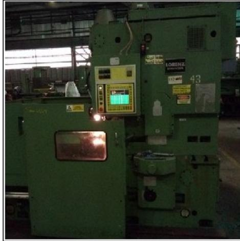
Figure III. 14 Machine à tailler les engrenages LS180CNC
