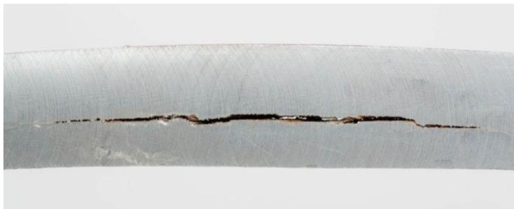
Figure I.18 Fragilisation par l'hydrogène
