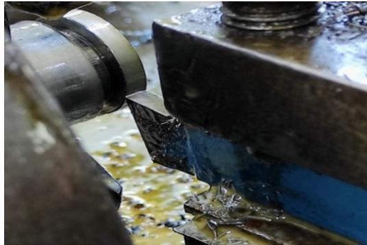
Figure II.13 Opération de tronçonnage
