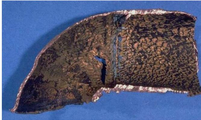
Figure I.19 Corrosion par érosion
