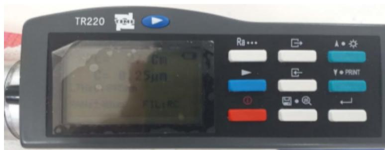
Figure II.8 Rugosimètre 2D TR220
