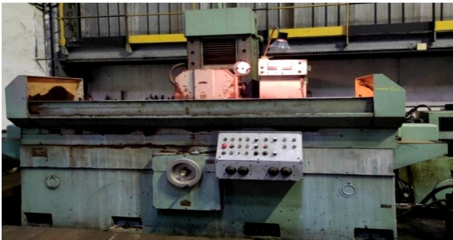
Figure II.17 Rectifieuse plane
