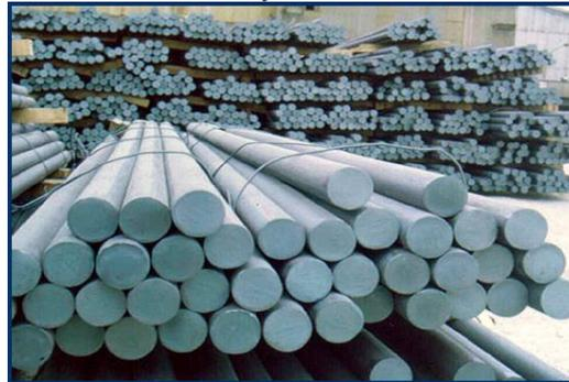
*Figure19 : Outils des broyeurs - Barres*
