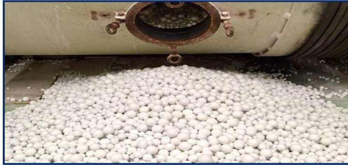
*Figure18 : Outils des broyeurs - Boulets en céramique*
