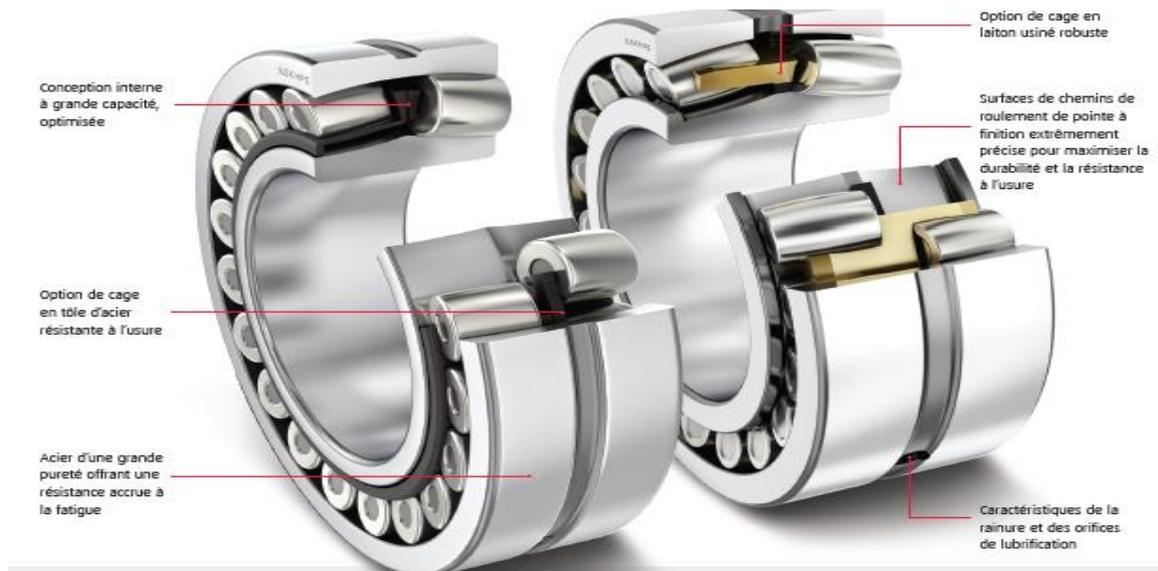
**Figure 57** : Roulements à rouleaux sphériques à alésage conique [source catalogue NSK]
