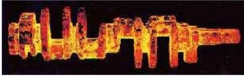
*Figure 38 :Exemple de pièce forgée à chaud (vilebrequin).*
