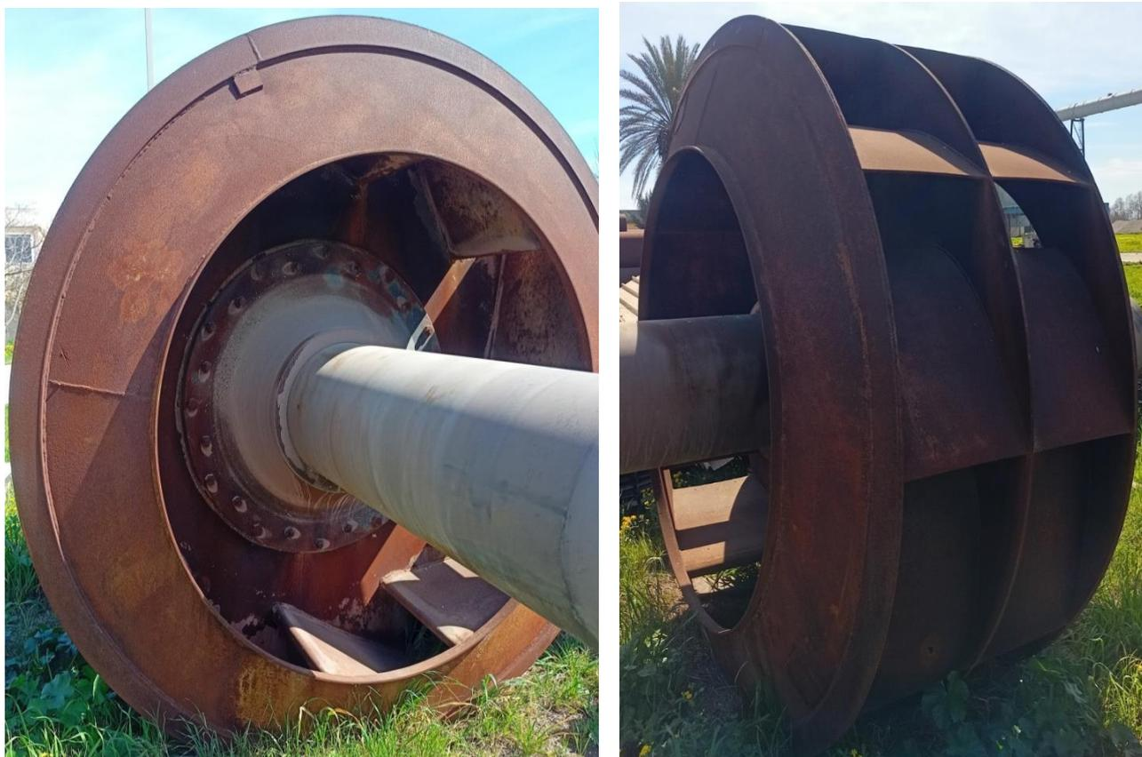
Figure I.11 : Roue du ventilateur
