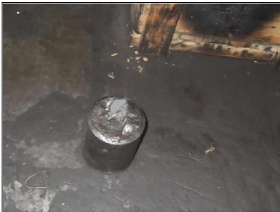
Figure IV.18 : photo d'une goupille rompue.
