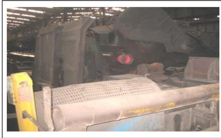
**Figure I.14 :** Scie à chaud.[2]
