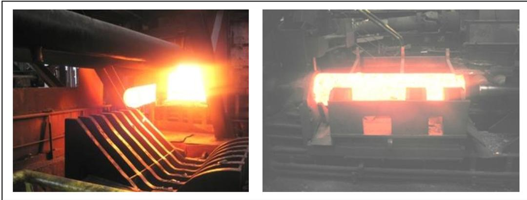
**Figure I.8 :** Défourneur four à sole [2].
