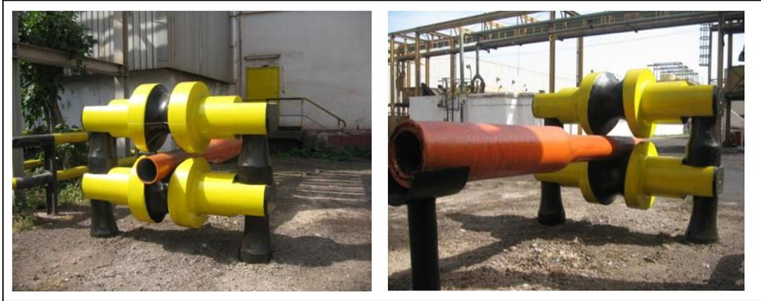
Il y a donc un Mouvement de va et vient de l'ébauche assuré par l'appareil de présentation. L'ensemble de Mouvements constitue un laminoir à pas de pèlerin.[2]
