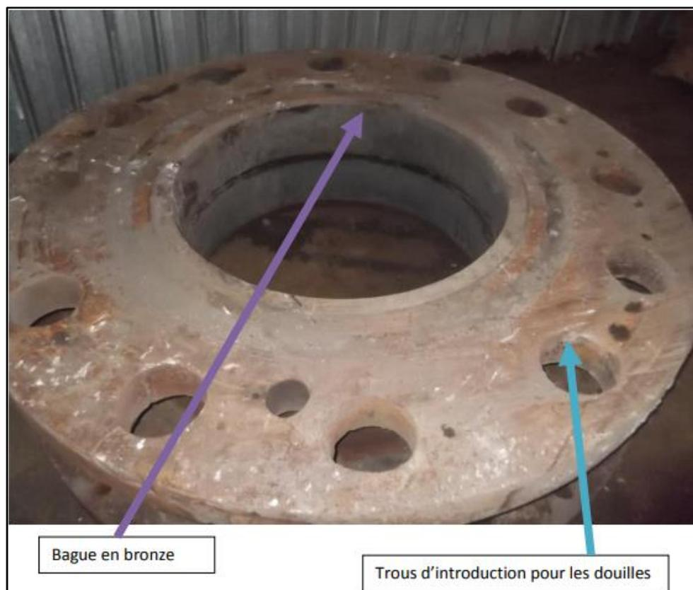
Figure IV.15 : Schéma présente le plateau de l'accouplement Holset.
