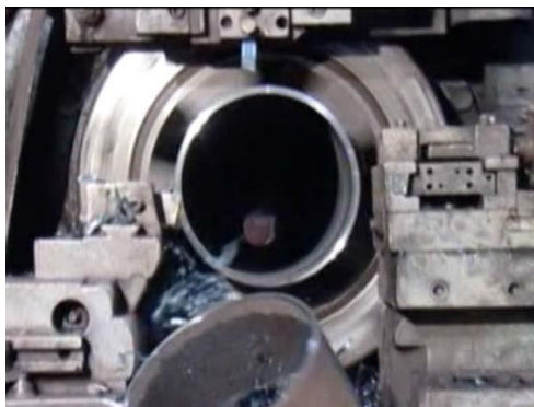
Tronçonnage des tubes
