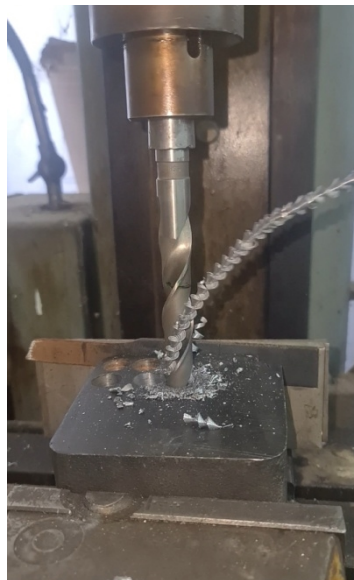
Figure III.4 : Dégagement de copeau lors du perçage
