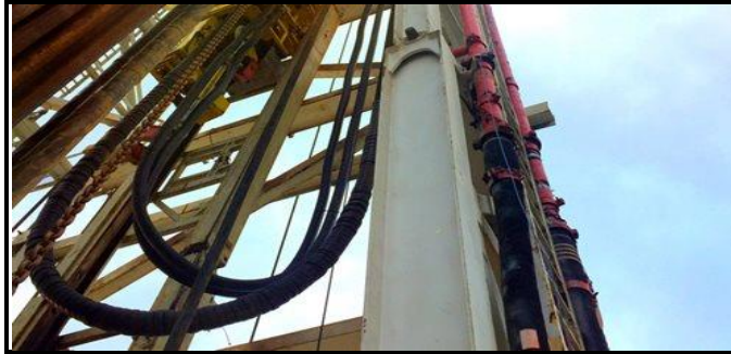
Figure I.22: Flexible d'injection de la boue de forage.
