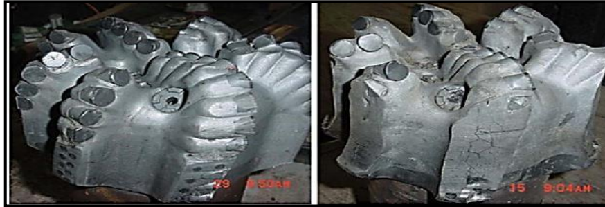
Figure III.8: Gauche: outil neuf, droite: outil ayant subi des vibrations sévères (Les chocs répétés entre la garniture et la paroi du puits peuvent élargir le trou dans certaines zones et sont responsables de la non-uniformité du diamètre de forage [33].
