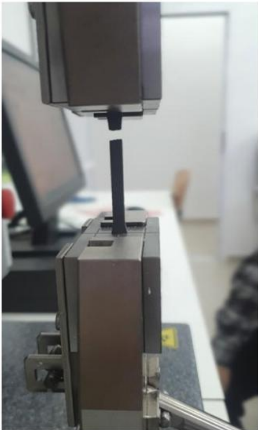
Rupture des éprouvettes à l'essai
