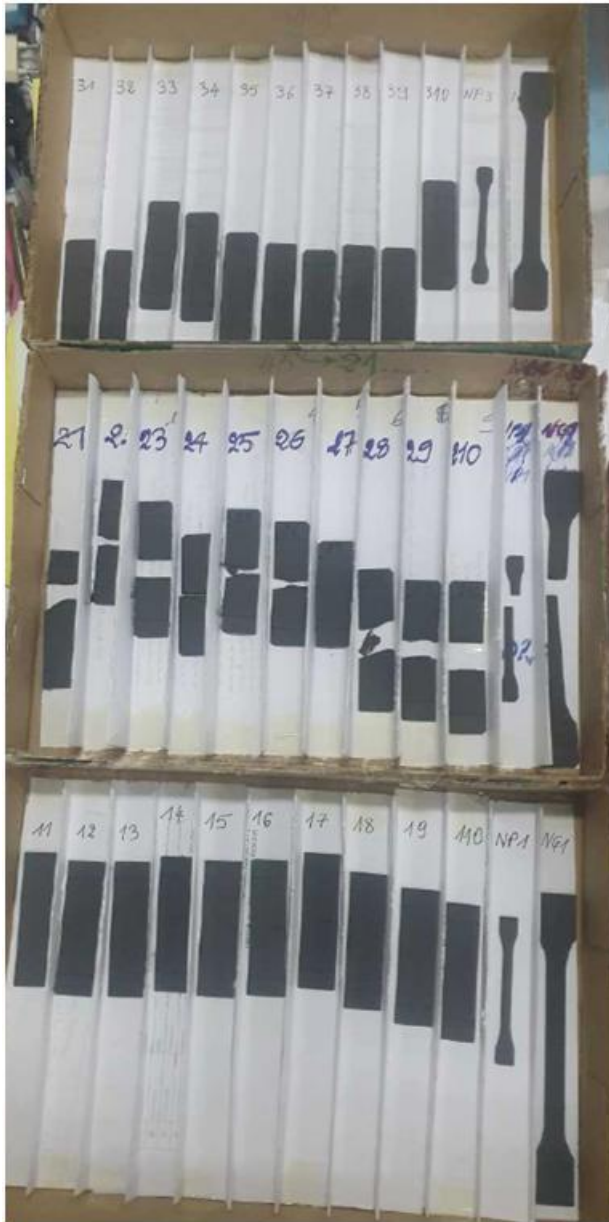
Fig. : Classification des éprouvettes avant et après essais
