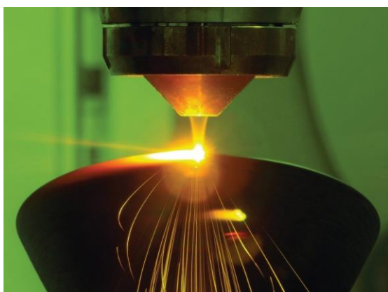
Figure.10 :l'impression 3D métallique avec le partenaire italien Sisma d'une buse coaxiale LMD
