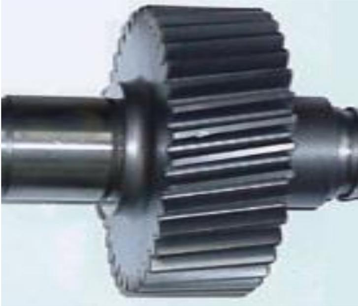
Figure 06 : Engrenages droits à denture hélicoïdale[7] .
