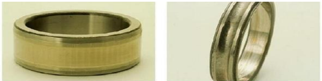
Figure 1-7: corrosion sur une piste de roulement [10].
