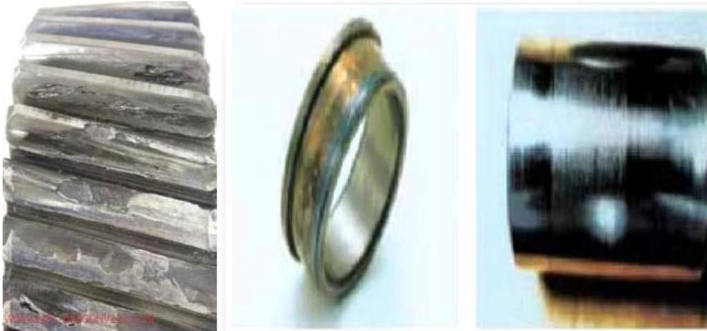
**Figure II.40:** Défauts de l'usure [51]
