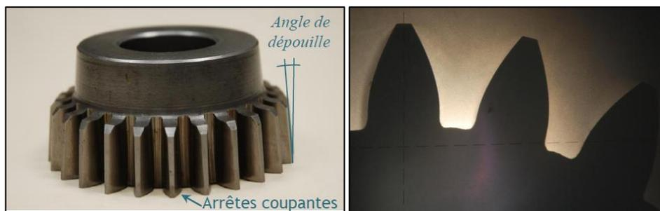
**Figure. II.25:** Dépouille des dents de l'outil pignon et son profil en développante de cercle.
