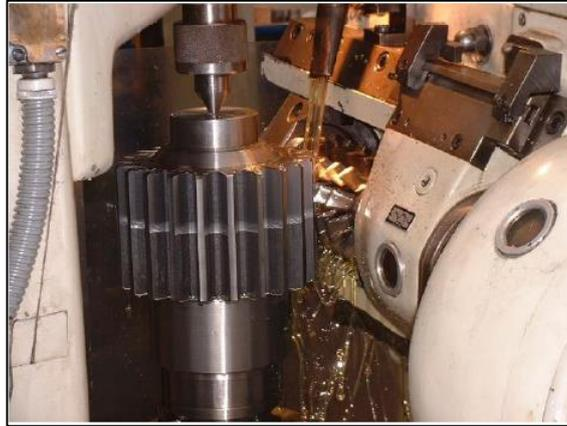
Figure. II .29 : Exemple de taille par fraise-mère [16].
