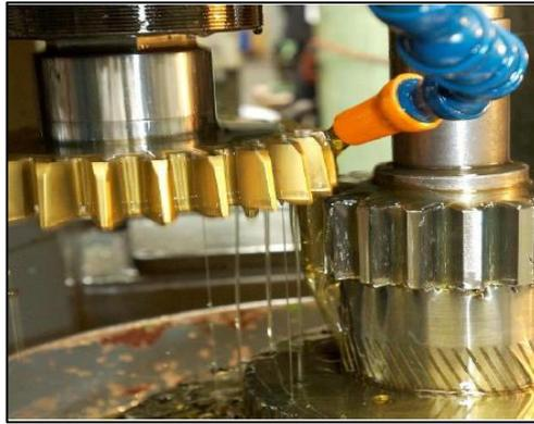
Figure. II.27 : Usinage de denture intérieure par outil pignon.[14]
