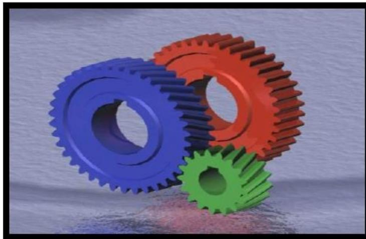
**Figure 11. 8 :** Denture droite et denture hélicoïdale : Les trois pignons ont le même module apparent et les deux grandes roues ont le même nombre de dents.
