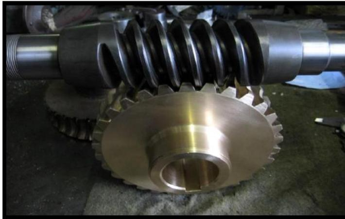
Figure 11.10 : Roue et vis sans fin.
