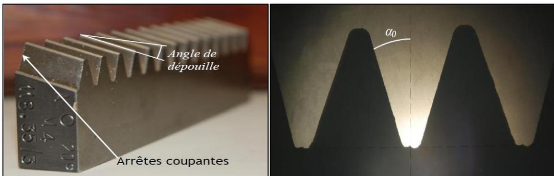
Figure. II.23 : Outil-crémaillère module  $m = 4$  et d'angle de pression  $20^\circ$  et son profil.[21]
