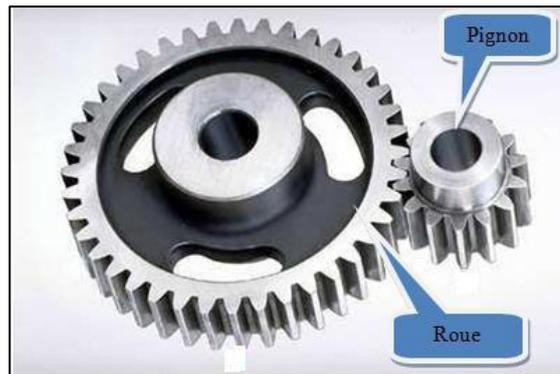
Figure. II.2 : Roue et pignon dans les engrenages [6].
