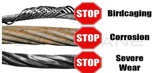
Figure I.19 : Dommages ou dégradation du câble métallique
