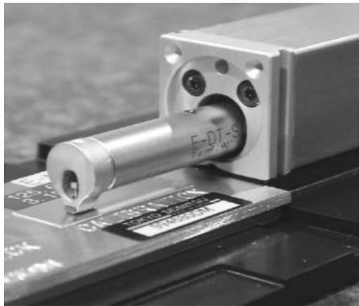
Figure II.13 : Rugosimètre avec patin
