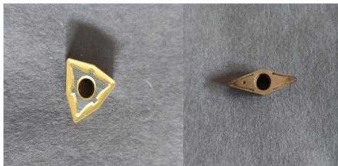
**Figure III.5 :** Pastille d'outil en carbure « SECO »
