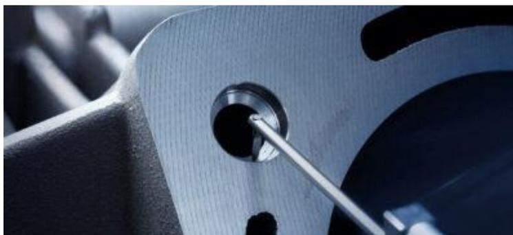
Figure II.14 : Rugosimètre avec patin.
