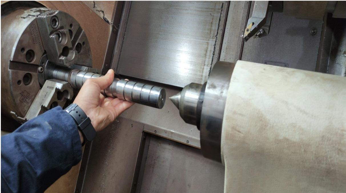
**Figure III.8 :** Montage de la pièce
