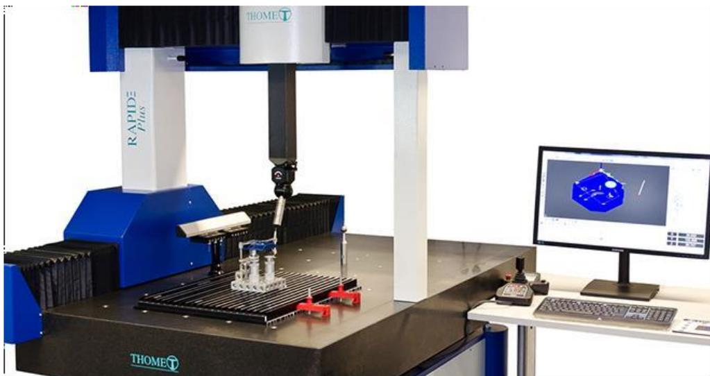
Figure II.15 : Appareille de mesure tridimensionnelle
