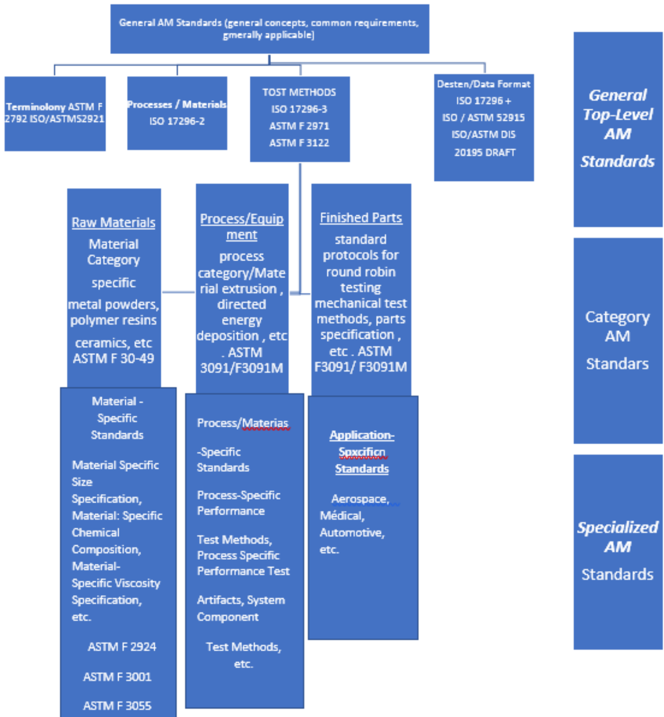
Fig2 : Normes et structure proposées par l'ASTM et ISO [9]
