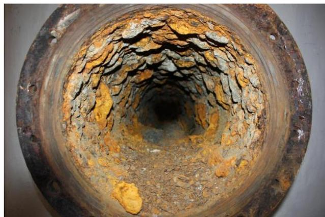
Figure 41 Corrosion par érosion
