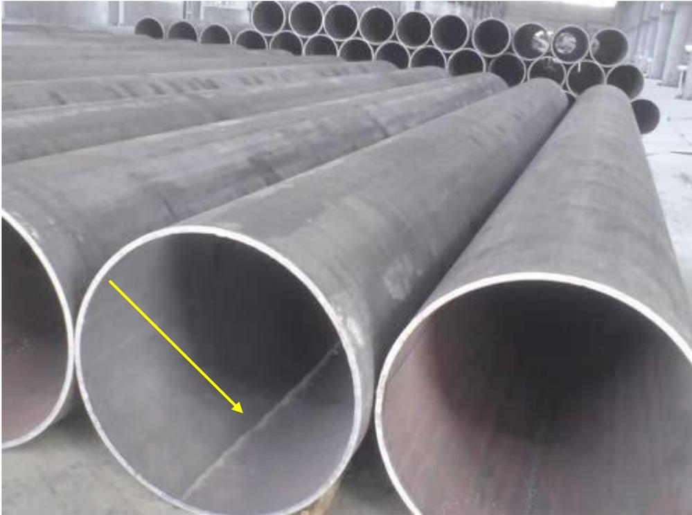
*Figure 5 Tube soudé longitudinalement*
