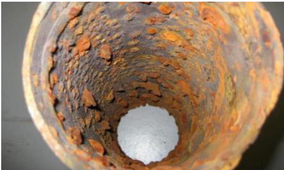
Figure 40 Corrosion microbiologique
