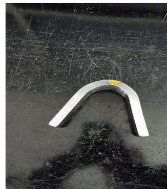
Figure 28 PLIAGE ET éprouvette plié
