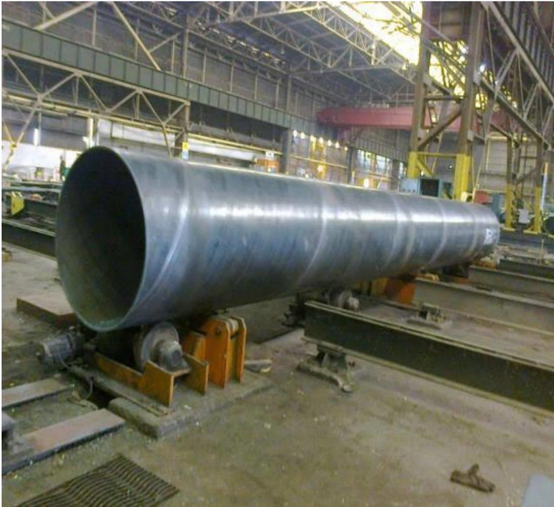
*Figure 3 tube soudé en spirale*
