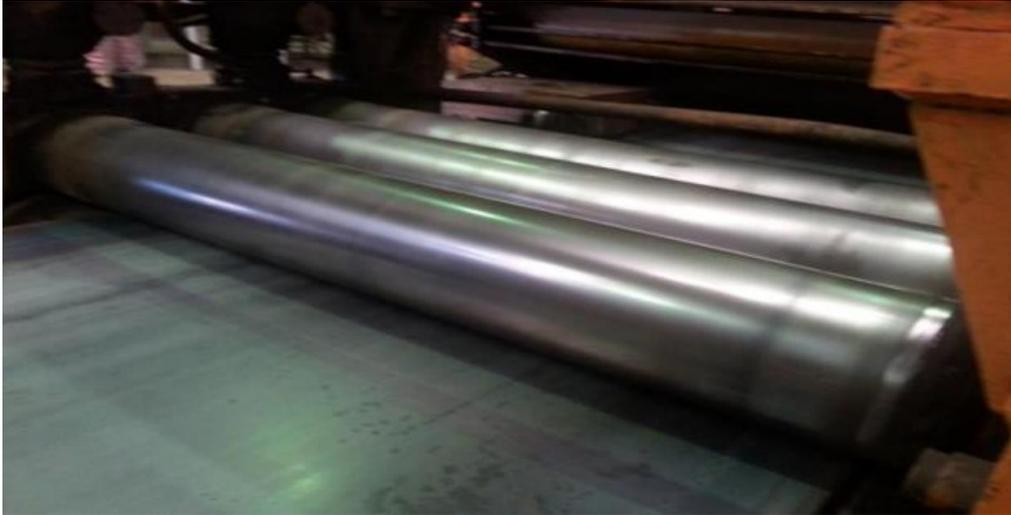
Figure 113 galets de guidage
