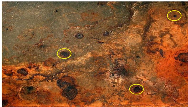
Figure 38 Corrosion par piqûres
