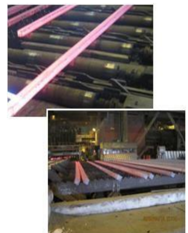
Figure I.10 - ripeur d'évacuation et refroidissement
