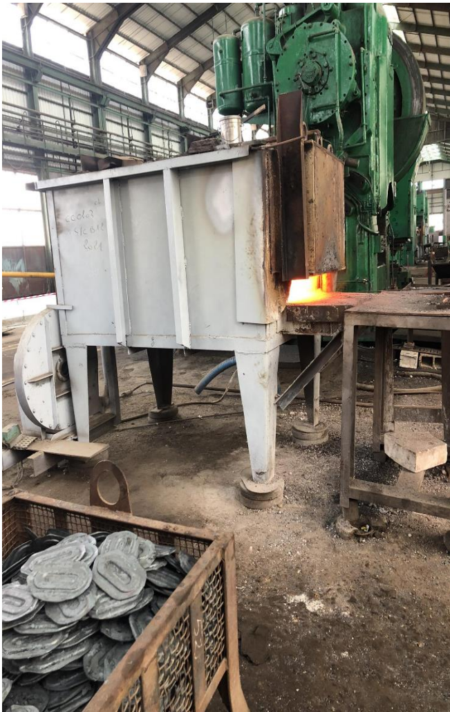
Figure 24 : Four de chauffage de lopin
