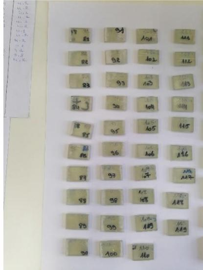
**Figure 21** : les éprouvettes des résines polyester utilisée.
