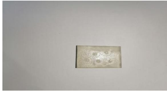
**Figure 45 :** les empreintes de la dureté Brinell
