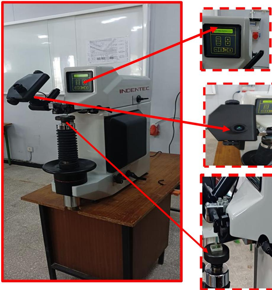
**Figure 38** : l'appareille de la dureté Rockwell
