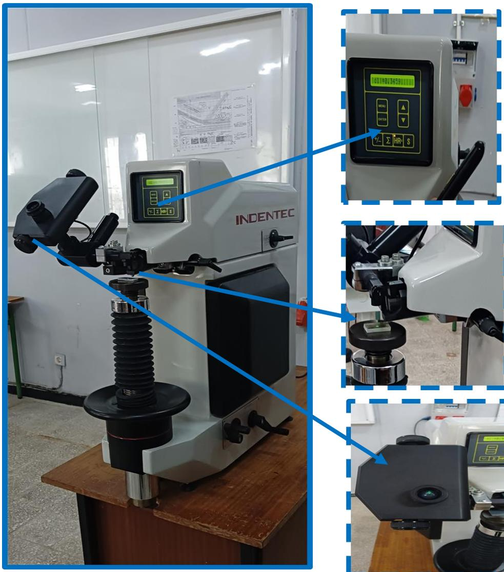
**Figure 41** : l'appareille de la dureté Brinell.
