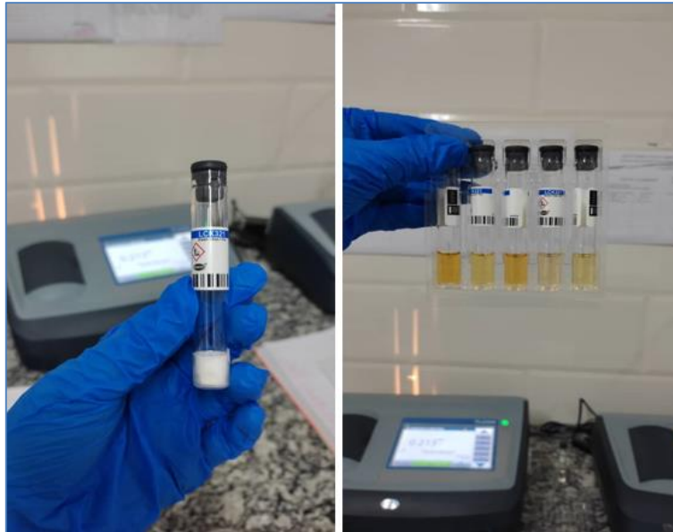
Figure II.28 : Mesure de fer (Fe)
