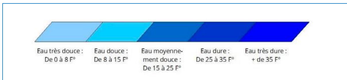
Figure I.3 : Evaluation de la dureté de l'eau par le titre hydrotimétrique.
