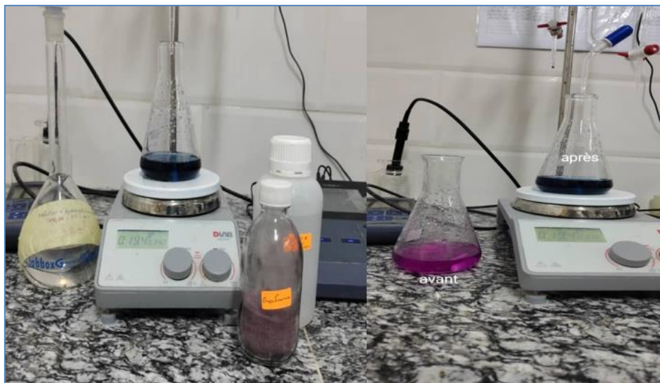
Figure II.23 : Détermination de la dureté (TH)
