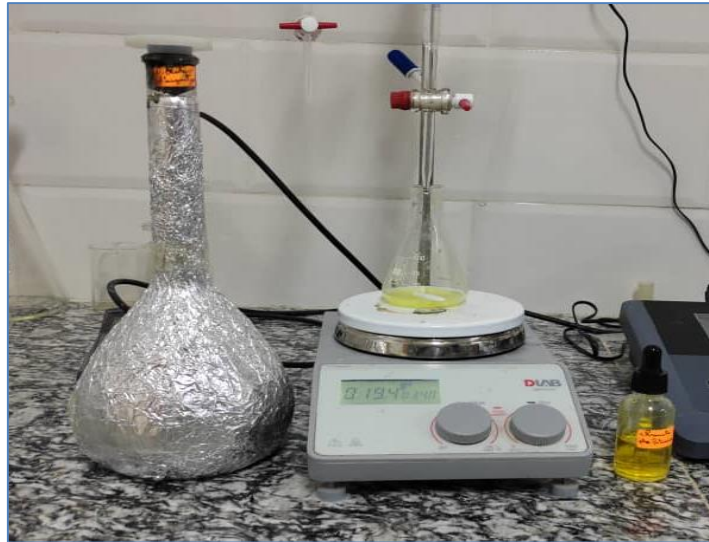
Figure II.29 : Dosage de chlorure
