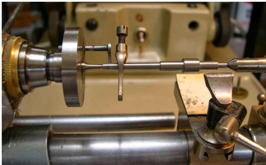
Figure.9 : Mise en position d'un cylindre long en montage entre pointe sur un tour et utilisation du doigt pousse toc.
