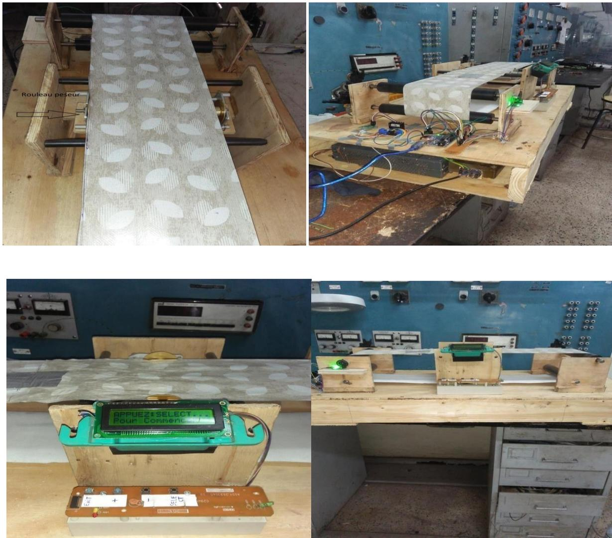
**Figure III.10 : plateforme prototype d'un doseur a bande**
