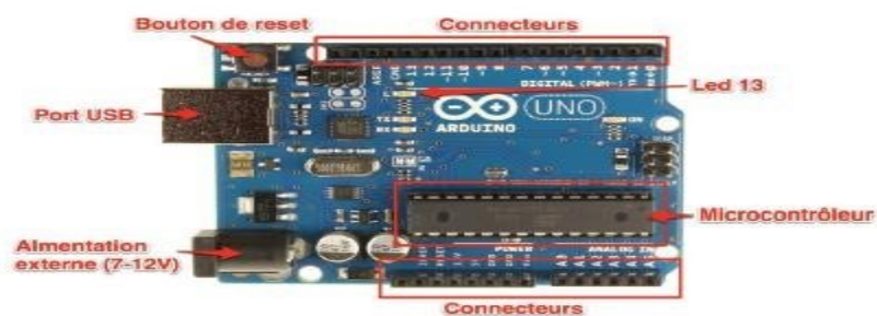
Figure III3 . Structure d'une carte Arduino UNO.
