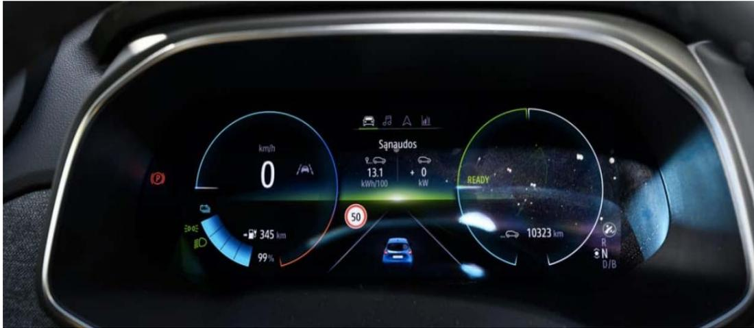
Figure **Erreur ! Il n'y a pas de texte répondant à ce style dans ce document.** représentant un tableau de bord d'un véhicule électrique lors du freinage régénératif
