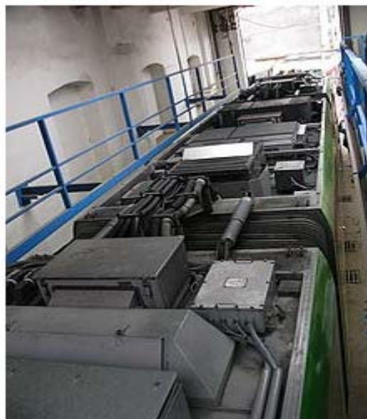
**Figure2.4** Système de freinage dynamique sur le toit d'un tramway
