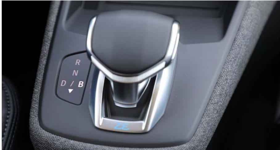
**Figure** Erreur ! Il n'y a pas de texte répondant à ce style dans ce document. **Le mode « B » permet le freinage régénératif sur la Renault ZOE**
